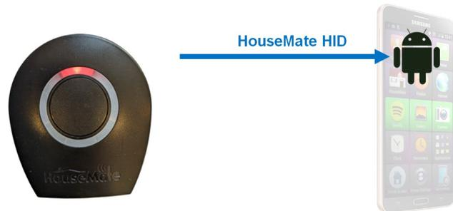
Nach einer erfolgreichen Verbindung leuchten die blauen LEDs auf, aber die rote LED leuchtet weiter und zeigt damit an, dass die Verbindung nicht vollständig ist.
