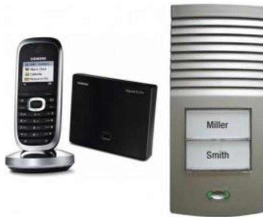
Das GigaSet HC450 ist so konfiguriert, dass es das Smartphone des Nutzers mittels seiner SIM-Karte anruft, wenn es an der Haustür klingelt. ClickToPhone erkennt, dass es einen Anruf von der Gegensprechanlage erhält, indem es die Mobilnummer der Gegensprechanlage identifiziert.
